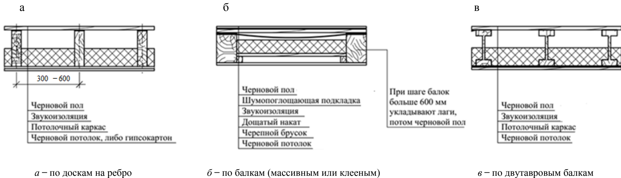
Рисунок А.4 – Конструктивные решения междуэтажных перекрытий
